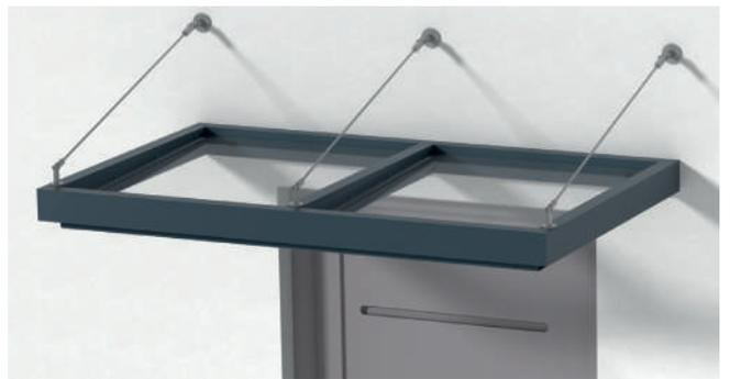
Structure aluminium soudé et thermolaqué 30 x 30 x 3 mm. Couverture polycarbonate ép. 4 mm traitée anti UV, vissée sur la structure. **Modèle 12** : Tôles pliées ép. 6 mm.
