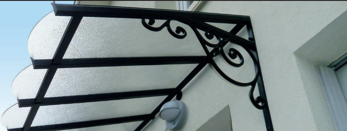
Structure aluminium soudée et thermolaquée 30 x 30 x 3 mm. Couverture en polycarbonate, ép. 4 mm traité anti UV, vissée ou collée. Volutes en option (sauf sur les modèles 13 et 14).
